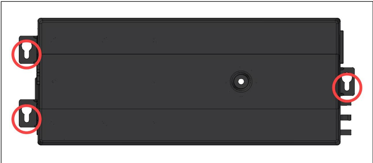
2. Die 3 Löcher vorbohren ( $\varnothing$  2.5 mm).
