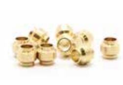
Le tuyau est fermement relié à la pompe ou au cylindre au moyen de la connexion à vis de serrage. La bague de serrage est sertie sur le tuyau en serrant la vis de connexion.
