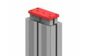
Cette plaque de base est vissée sur le pied central SM. Les trois filetages M10 permettent de visser des pieds réglables ou des roulettes.
