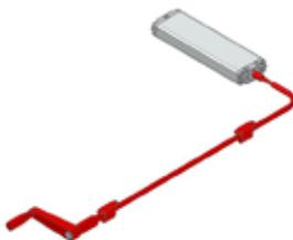
La manivelle peut être décalée de la pompe au moyen d'un renvoi d'angle à 90°. La partie droite a une longueur de 1m. mais peut être adaptée à la longueur désirée.
