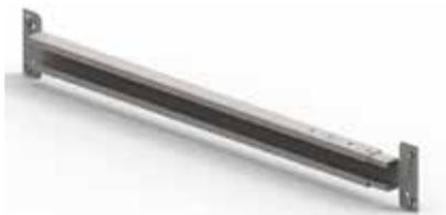
Pezzo di collegamento telescopico per le colonne di sollevamento SL, SM, TL e TM. La traversa può essere facilmente spinta nelle scanalature (larghe 8 mm) della colonna di sollevamento e bloccata con una chiave esagonale.
