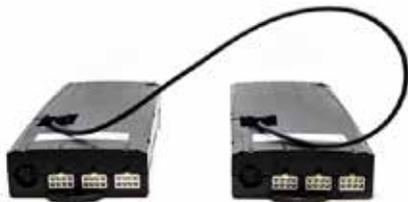
Col cavo SYNC-2 è possibile sincronizzare 2 centraline. Entrambe le centraline opereranno in parallelo.
