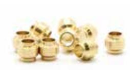
A causa della connessione con anello di serraggio, il tubo idraulico viene fissato saldamente alla pompa, rispettivamente al cilindro. L'anello di serraggio si comprimerà sul tubo quando si stringe la vite di collegamento.
