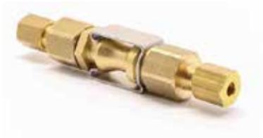
La chiusura a scatto per accoppiare dei tubi si usa per staccare il tubo senza perdere l'olio. L'accoppiamento e il disaccoppiamento sono possibili fino ad una pressione massima di 30 bar.
