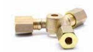
Mit dem Y-Stück können zwei Druckelemente mit einem Zylinder verbunden werden. Die Hubgeschwindigkeit wird somit verdoppelt, und die Traglast halbiert.
