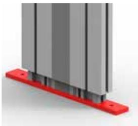
Die Fussplatte TT wird an die Hubsäule TT geschraubt und kann mithilfe der zwei Bohrungen  $\varnothing 9$  mm an Gestelle oder in den Boden geschraubt werden.
