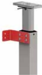
Mit der Winkelbefestigung kann die Hubsäule TA an eine Wand befestigt werden. Die Winkelbefestigung wird an der Anschweißplatte der Hubsäule mit vier M6 Schrauben angeschraubt.
