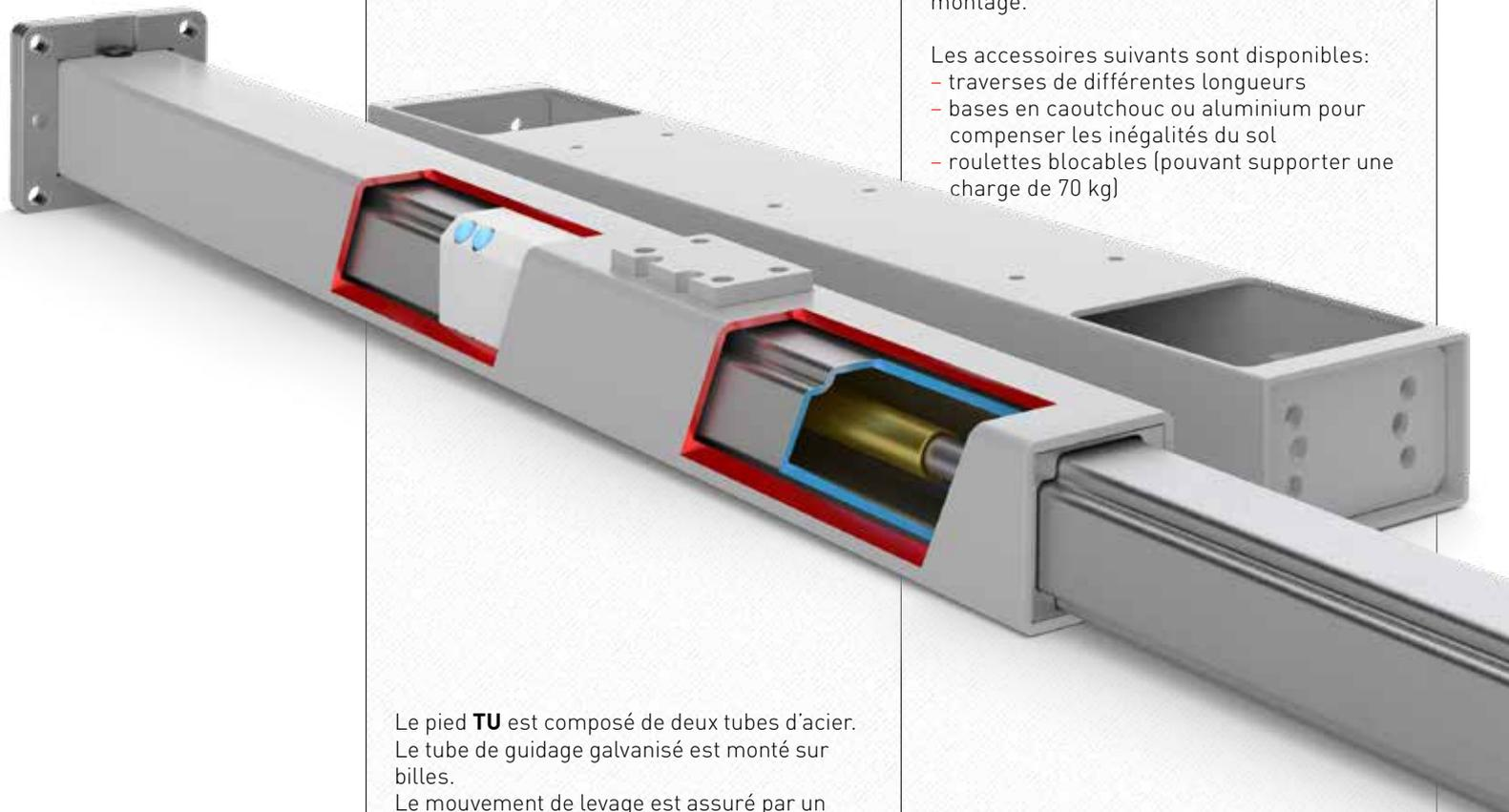
Le pied **TU** est composé de deux tubes d'acier. Le tube de guidage galvanisé est monté sur billes. Le mouvement de levage est assuré par un vérin hydraulique.
