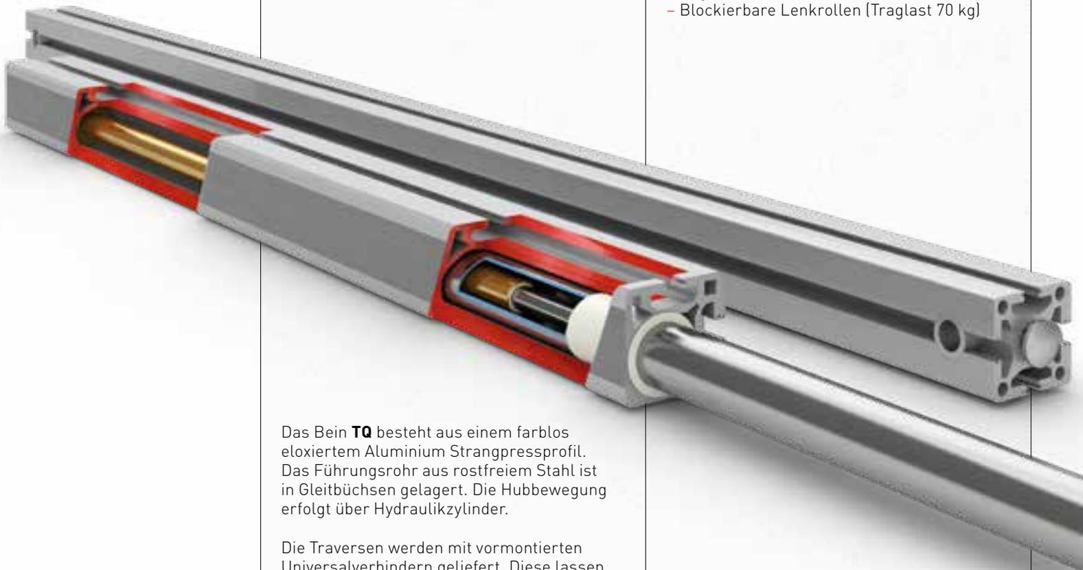
Das Bein **TQ** besteht aus einem farblos eloxiertem Aluminium Strangpressprofil. Das Führungsrohr aus rostfreiem Stahl ist in Gleitbüchsen gelagert. Die Hubbewegung erfolgt über Hydraulikzylinder.
