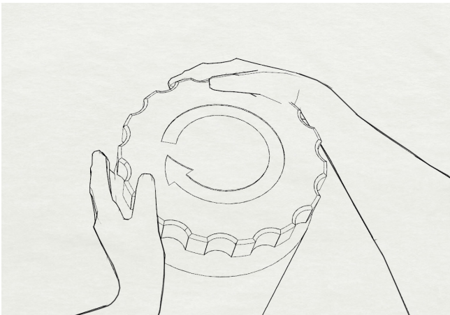
Figure 10 Il convient d'éviter les positionnements extrêmes du poignet. La main gauche doit en particulier être fortement tendue vers l'arrière (extension dorsale).
