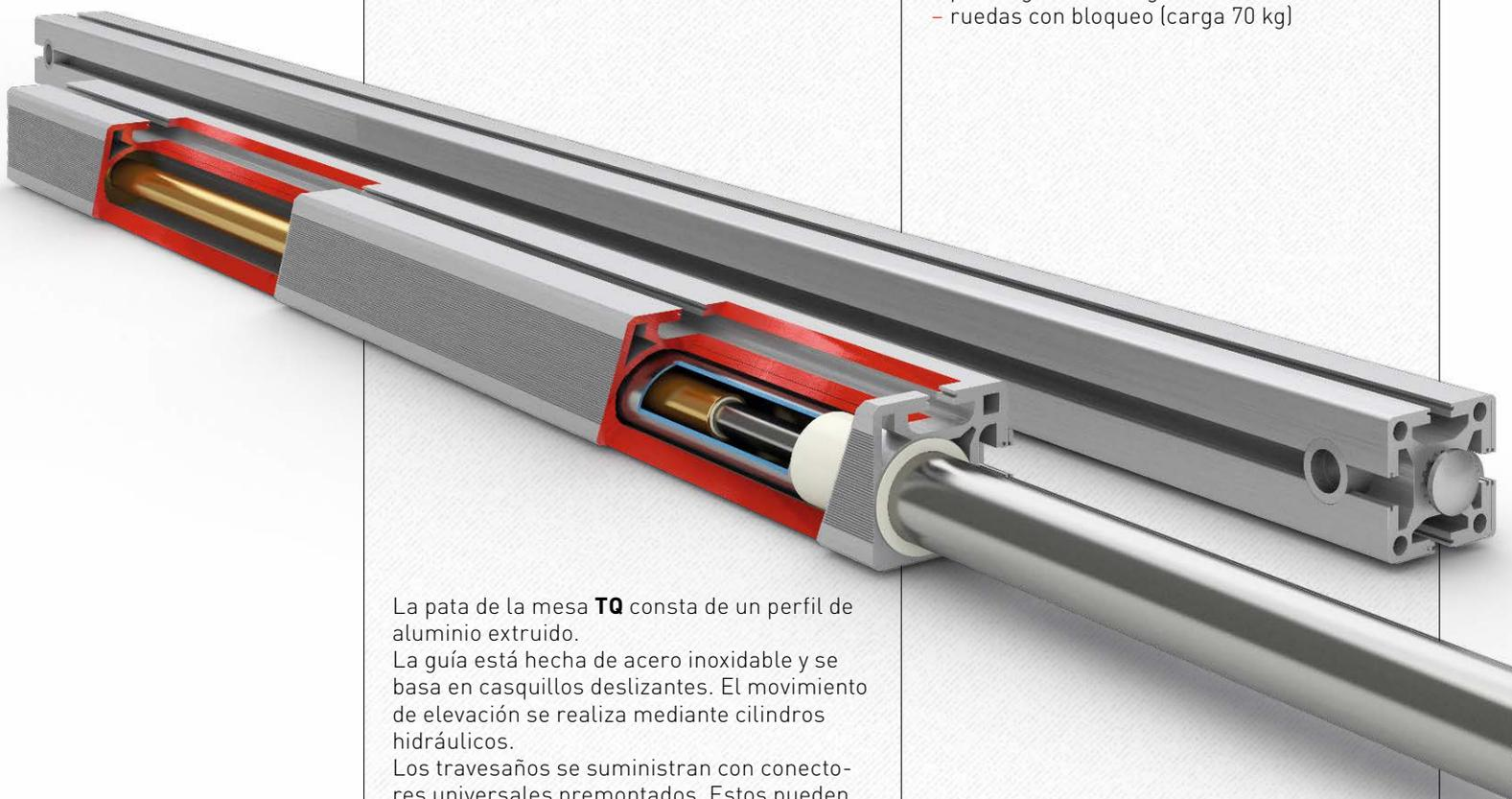
La pata de la mesa **TQ** consta de un perfil de aluminio extruido. La guía está hecha de acero inoxidable y se basa en casquillos deslizantes. El movimiento de elevación se realiza mediante cilindros hidráulicos. Los travesaños se suministran con conectores universales premontados. Estos pueden insertarse en las patas de la mesa y fijarse en su lugar con una conexión de tornillo cónico.
