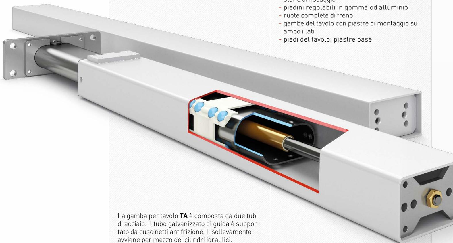
La gamba per tavolo **TA** è composta da due tubi di acciaio. Il tubo galvanizzato di guida è supportato da cuscinetti antifrizione. Il sollevamento avviene per mezzo dei cilindri idraulici.
