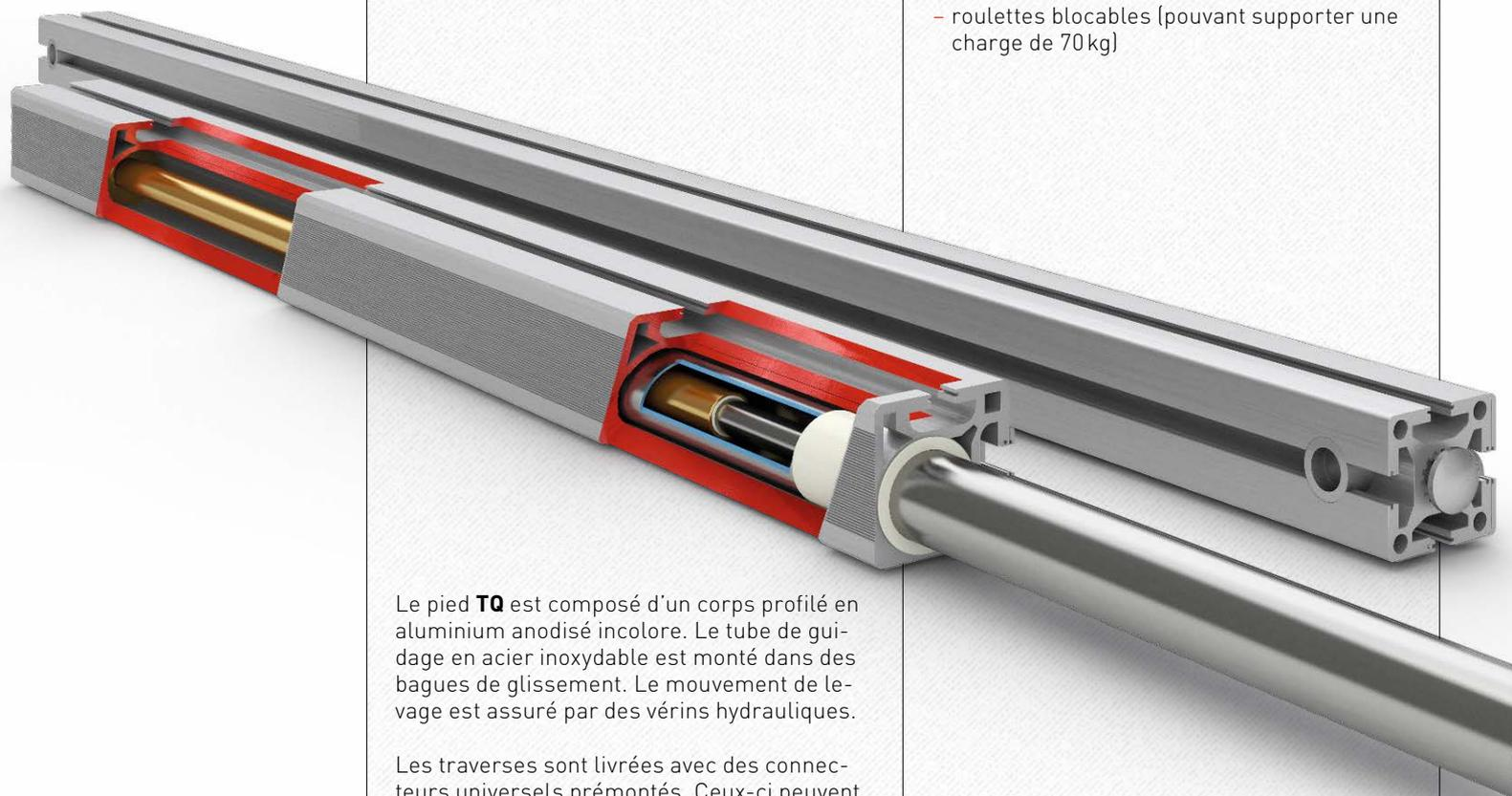
Le pied **TQ** est composé d'un corps profilé en aluminium anodisé incolore. Le tube de guidage en acier inoxydable est monté dans des bagues de glissement. Le mouvement de levage est assuré par des vérins hydrauliques.
