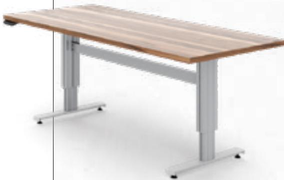
Das Untergestell **SM-4** besteht aus vier Hubsäulen, welche im Rechteck angeordnet und mit Traversen verbunden werden. Die Hubsäulen werden mit einer Fussplatte inkl. Regulierfuss versehen. Die Tischplatte wird direkt an den Adapterplatten der Hubsäule **SM** befestigt.
