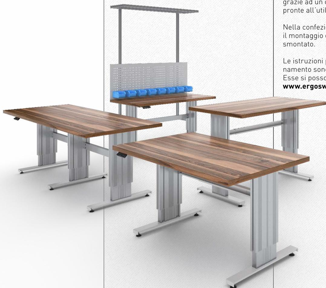
Il telaio base **SL** è composto da 2 colonne di sollevamento, da una traversa e da 2 basi del tavolo. La traversa scorre facilmente dentro le cave della colonna di sollevamento e viene fissata utilizzando una chiave a brugola.
